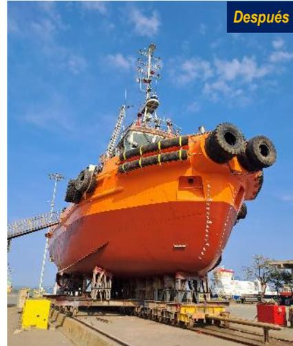
Preparación de superficie y pintura en casco, mantenimiento y calibración de válvulas, cambio de tuberías, asistencia técnica al sistema de propulsión, y desmonte y montaje de defensas.
