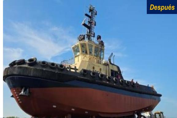
Cambios de acero en casco, alineación Sistema de propulsión; preparación superficie y pintura casco; mantenimiento válvulas de fondo y descarga, entre otros y comunicaciones.
