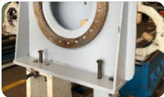
Diseño y construcción de un banco de pruebas para cajas de sellos que logre simular las condiciones de funcionamiento del elemento, identificando posibles fallas y defectos de este en un ambiente controlado con la posibilidad de correcciones previas al armado final a bordo.
