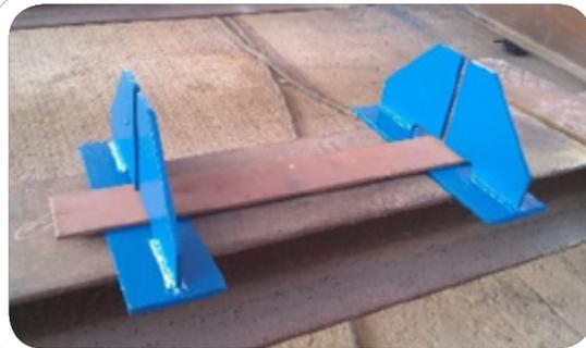
Se construyeron 4 dispositivos para armar y sujetar platinas con el fin de construir las previas de refuerzos estructurales como T y L para columnas y vigas. Y se construyeron 2 dispositivos para puntear ángulos de 2-1/2" directamente sobre las cubiertas, mamparos y otros. Con estos dispositivos se redujo el tiempo de la actividad del conformado de previas en un 50%.
