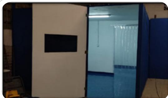
Se diseñó y construyó una cabina de 7mts de largo y 3,6mts de ancho para desarrollar trabajos en fibra de vidrio. Cuenta con extracción y luces, está dividido en dos áreas, una para fabricación y laminado y la otra para corte y almacenamiento de sustancias químicas.
