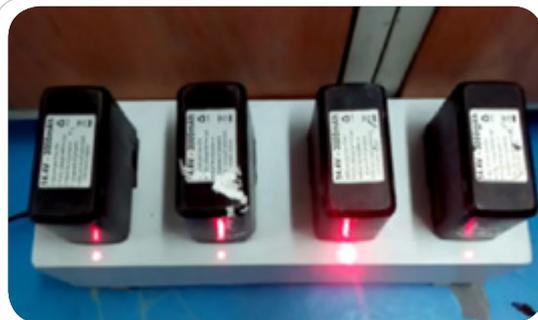
Diseño y construcción de un banco de carga para baterías del sistema BUG-O, que consta de una caja de fibra de vidrio adaptada para cargar 4 baterías independientes y de manera simultánea.
