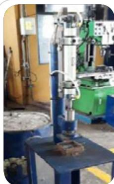
La máquina fue fabricada con materiales recuperados y un pistón fabricado para la parte mecánica. Funciona con un sistema a presión neumática para realizar las marcaciones de las marquillas de las tuberías, lo cual facilita la ubicación de éstas en la embarcación.
