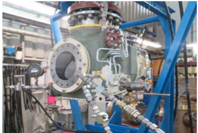
Ilustración 63 - Cambio de Válvulas VIGE y VEGE Submarinos A206
