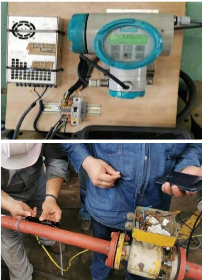
Ilustración 61 - Comparación del flujo con patrón y montaje del sensor de flujo en la ARC "Caldas".
