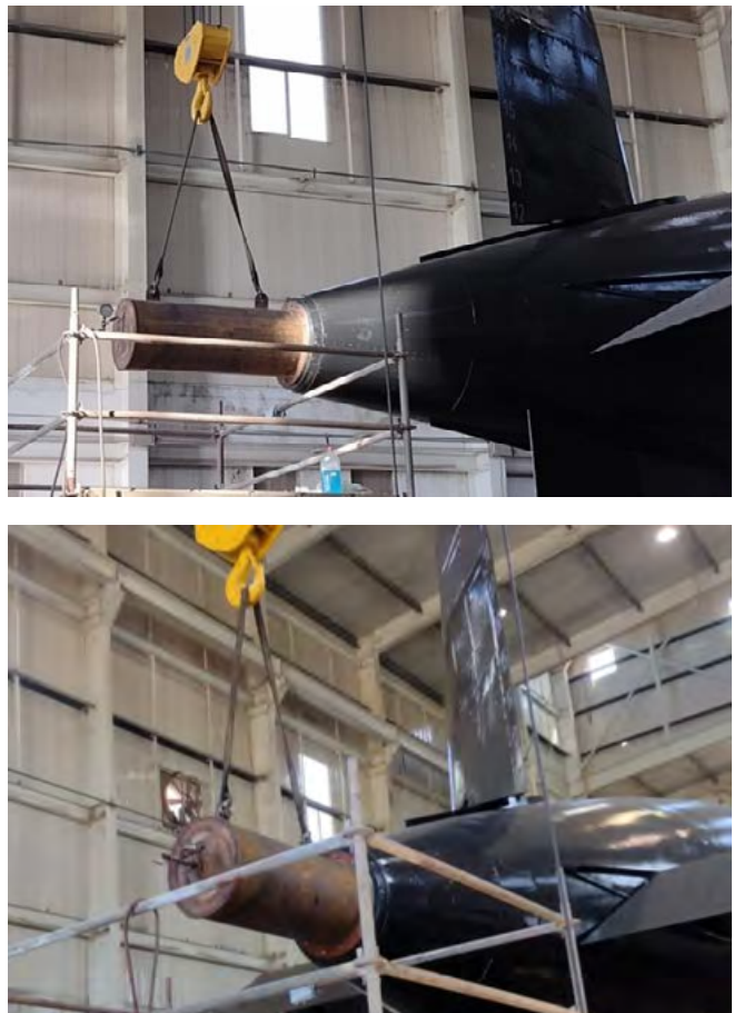
Ilustración 60 - Dispositivo de Pruebas de estanqueidad en Submarinos.
