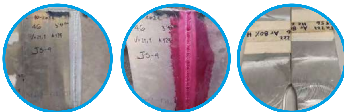
Materiales y probetas empleadas en aplicación de soldadura en Aluminio.
