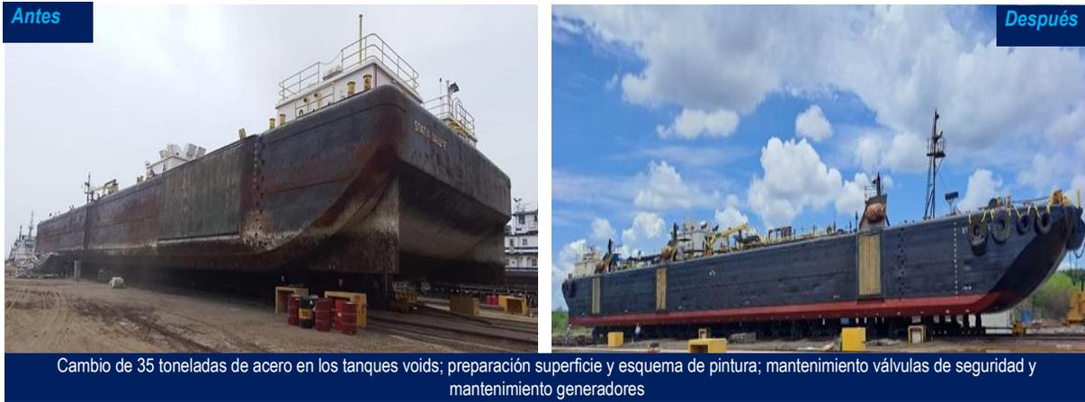
Cambio de 35 toneladas de acero en los tanques voids; preparación superficie y esquema de pintura; mantenimiento válvulas de seguridad y mantenimiento generadores
