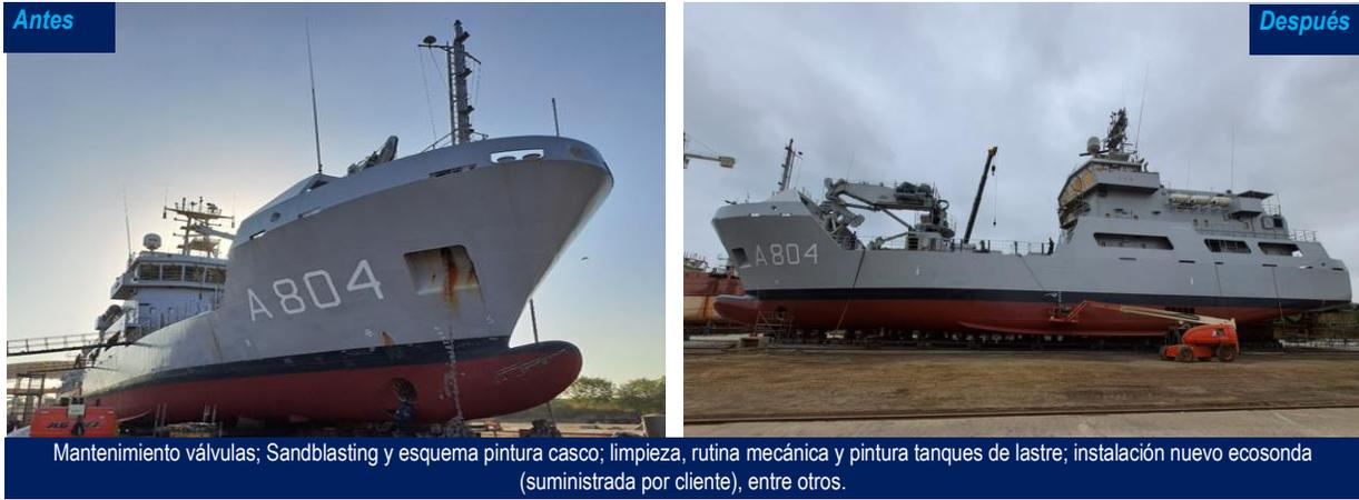
Mantenimiento válvulas; Sandblasting y esquema pintura casco; limpieza, rutina mecánica y pintura tanques de lastre; instalación nuevo ecosonda (suministrada por cliente), entre otros.
