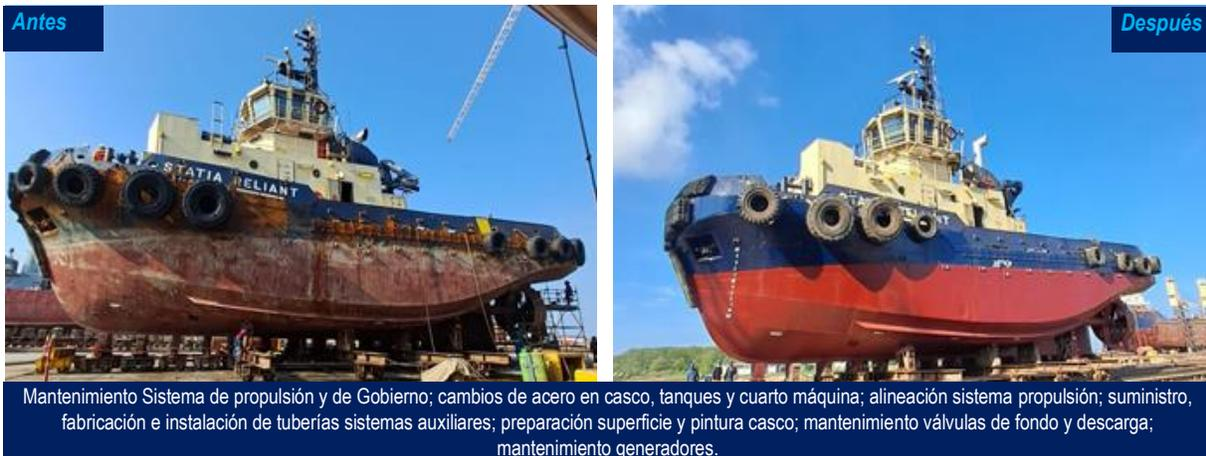
Mantenimiento Sistema de propulsión y de Gobierno; cambios de acero en casco, tanques y cuarto máquina; alineación sistema propulsión; suministro, fabricación e instalación de tuberías sistemas auxiliares; preparación superficie y pintura casco; mantenimiento válvulas de fondo y descarga; mantenimiento generadores.
