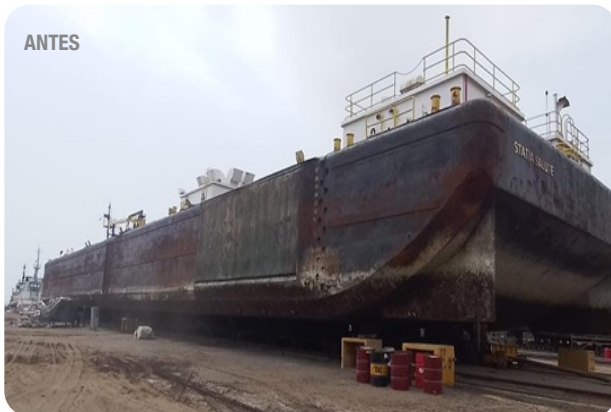
Cambio de 35 toneladas de acero en los tanques voids; preparación superficie y esquema de pintura; mantenimiento válvulas de seguridad y mantenimiento generadores
