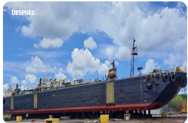
Cambio de 35 toneladas de acero en los tanques voids; preparación superficie y esquema de pintura; mantenimiento válvulas de seguridad y mantenimiento generadores
