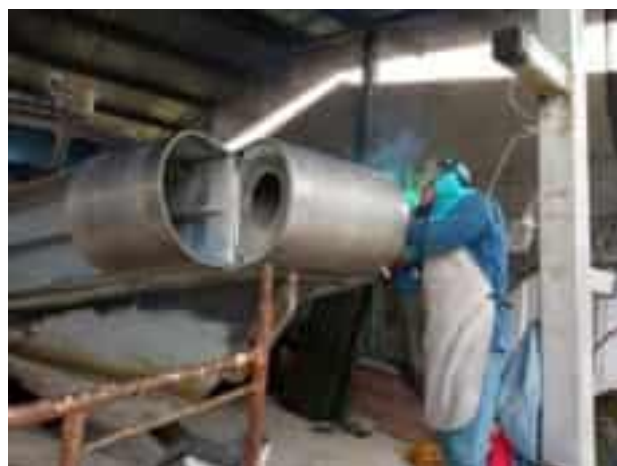
Ilustración 59. Mejora diseño defensa estructural embarcaciones de aluminio
