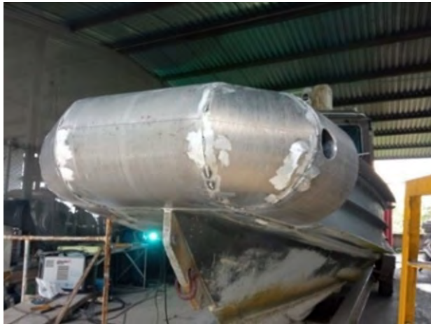
Ilustración 59. Mejora diseño defensa estructural embarcaciones de aluminio
