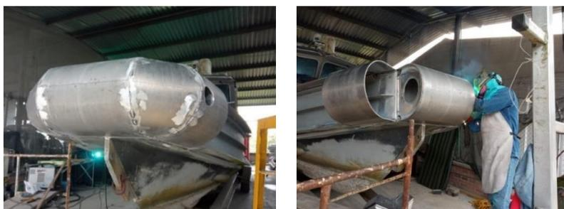
Ilustración 47. Mejora diseño defensa estructural embarcaciones de aluminio
