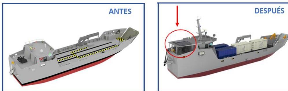
Ilustración 44. Buque BALCL - Extensión de cubierta 02 para la instalación de paneles solares.
