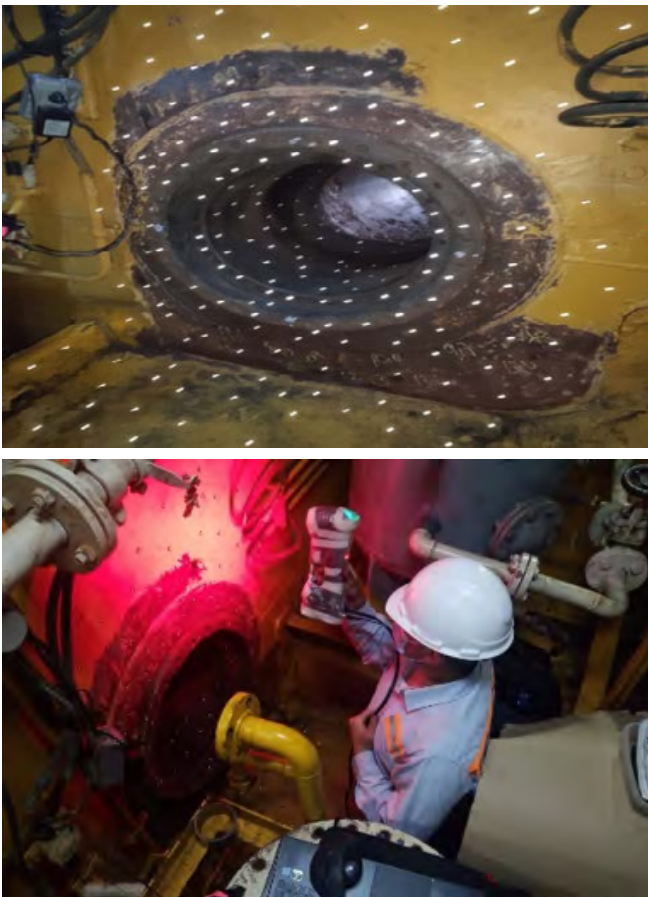
Ilustración 59 - Control dimensional utilizando tecnologías 3D.
