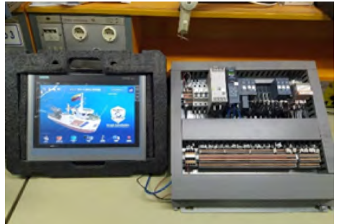
Ilustración 65 - Capacidad sistemas AMS "Alarm and Monitoring System"
