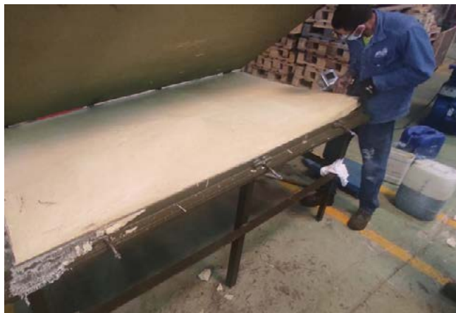
Ilustración 57 - Mesa de fabricación de láminas de poliuretano
