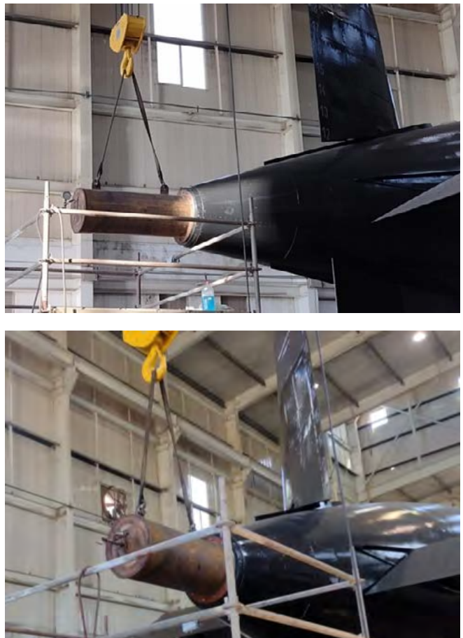
Ilustración 60 - Dispositivo de Pruebas de estanqueidad en Submarinos.
