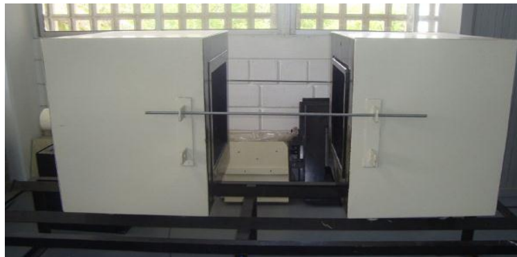
Imagen 6. Dispositivo para la medición del coeficiente global de transferencia de calor (Caja Caliente)
