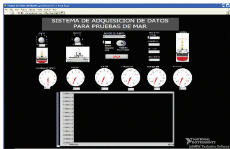
Imagen 16. Panel de control de los programas de adquisición de datos utilizando dos computadores en red
