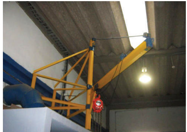
Imagen 29. Sistema pescante para levantar pesos superiores a 2 Tons.
