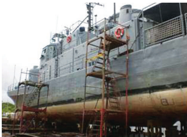
Imagen 25. Embarcación en posición de varada para trabajos de preparación de superficies
