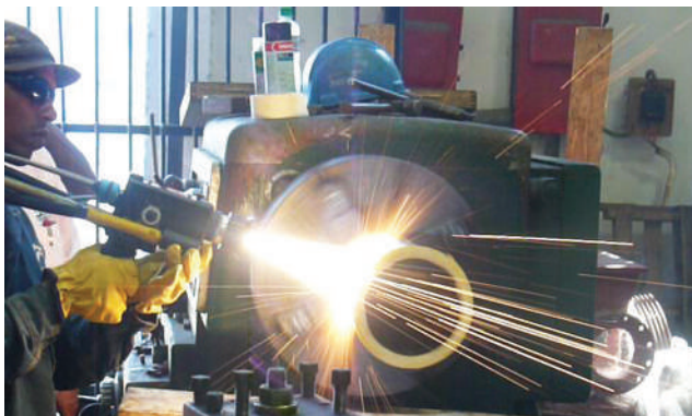
Imagen 22. Implementación de la proyección térmica por arco
