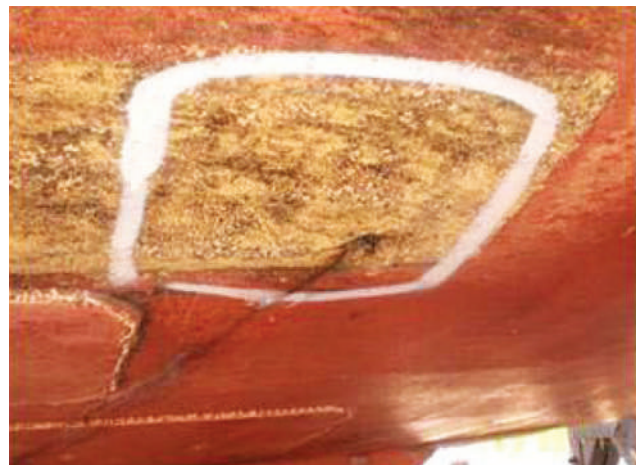
Imagen 26. Corrosión en casco de buque
