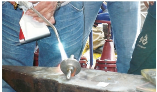
Imagen 23. Implementación de la proyección térmica por llama
